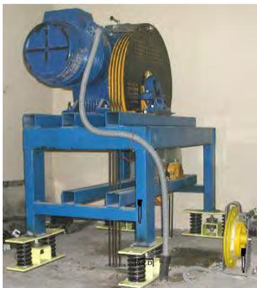
**Fig 2. Amortiguación de maquinaria**
