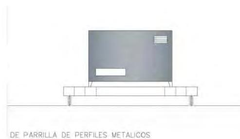
**Fig 6.** Bancada de parrilla de perfiles metálicos
