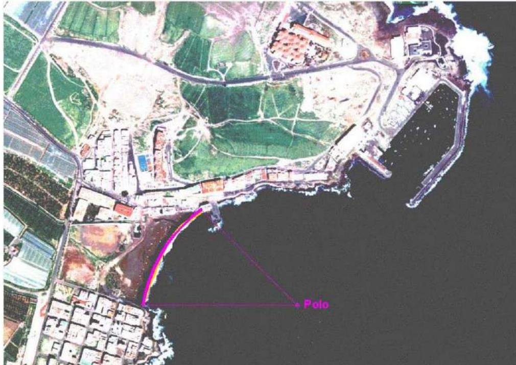
**Figura 5.** Ajuste de espiral logarítmica a la costa (Matlab).
