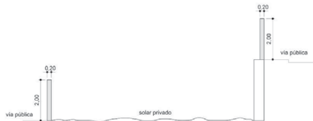
Cerramiento del solar o parcela con desniveles
