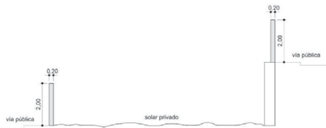
Cerramiento del solar o parcela con desniveles
